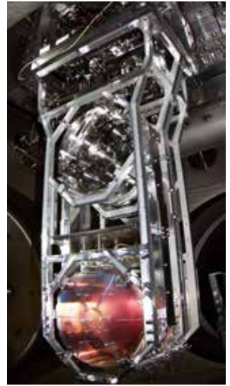
5.34 Spiegel in vierfach entkoppelter Aufhängung
